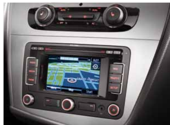
Мультимедийная система SEAT 2.2 с интерфейсом Bluetooth*, сенсорный ЖК - экран, система навигации.
