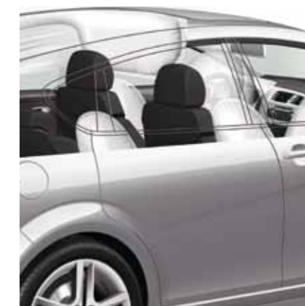
Задняя боковая подушка безопасности для защиты головы и грудной клетки.
