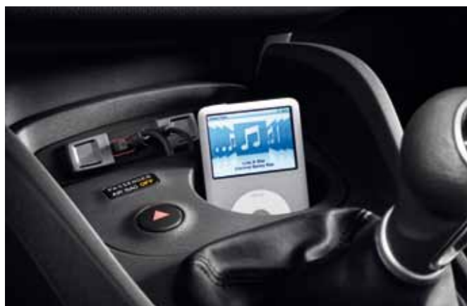
Комбинированный разъем: USB-порт / аудиоразъём AUX-in (CUP) для подключения плеера iPod* и MP3.
